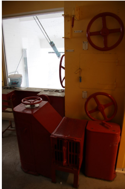
Styringspult fra 1950-årene og opprinnelig bremsemaskineri og nøddriftshjul i den gamle driftssentralen/kontrollrommet.
