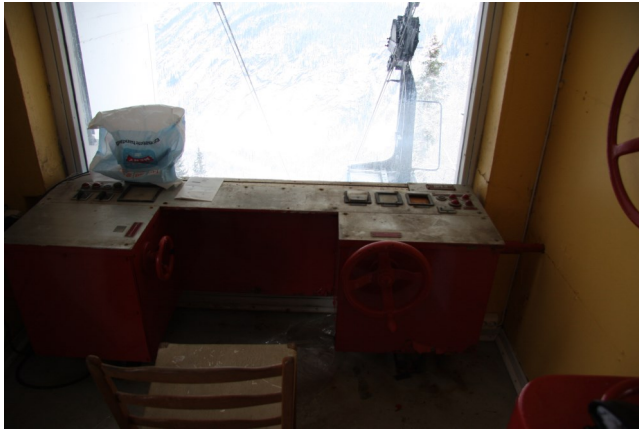
Styringspult fra 1950-årene og opprinnelig bremsemaskineri og nøddriftshjul i den gamle driftssentralen/kontrollrommet.
