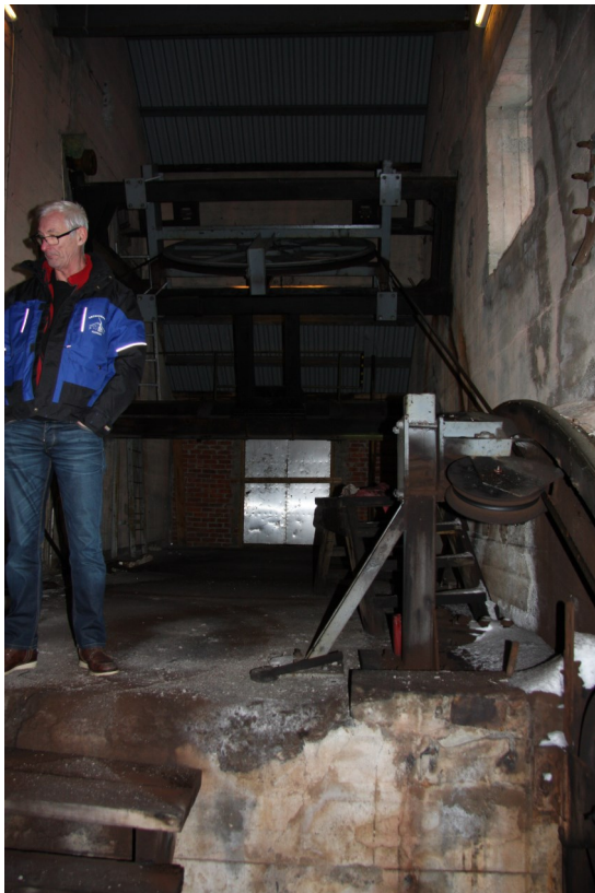
Drivverksrommet. Drivverket som brukes er det samme som i 1928, men de to hjulene for trekk-kabelen er erstattet av ett nytt.
